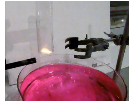
Reagenzglas ist nun vollständig mit H 2 befüllt
