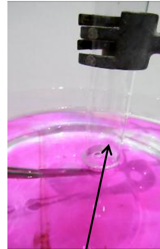
Reagenzglas ist nun vollständig mit H 2 befüllt
